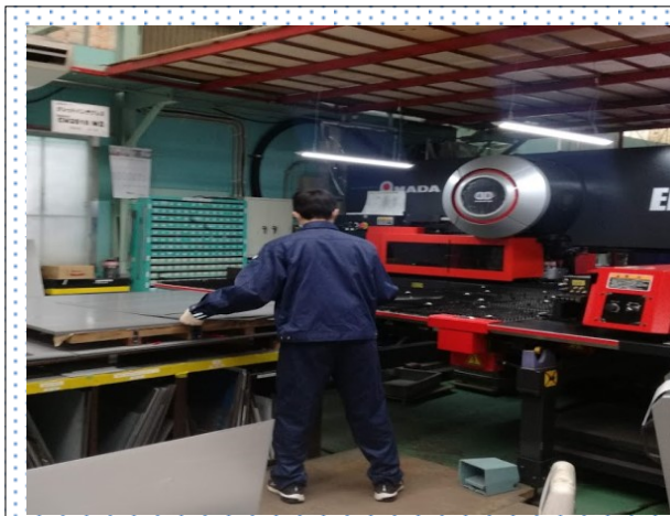
1ヶ月の就業体験①で、デュアルシステム科の2年生にNCタレットパンチングプレスを操作してもらいました。
