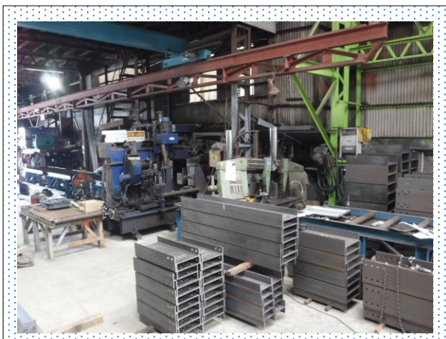
鋼材の一次加工機（穴あけ・切断・開先加工）
