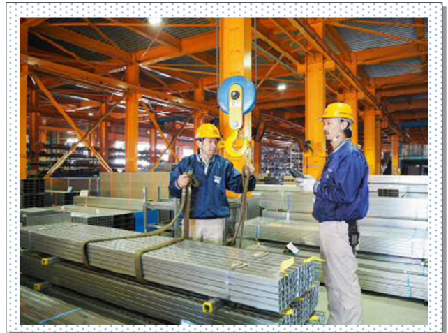
作業現場の様子 (天井クレーン)
