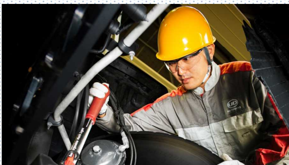
点検灯を使用した整備状況確認
