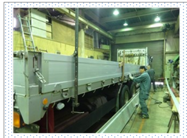
煽（あおり）の取り付け作業
