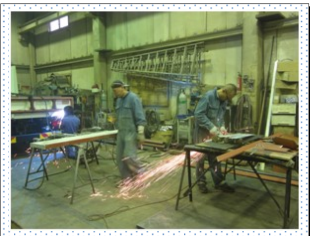
車体の形状となる鉄板の加工作業
