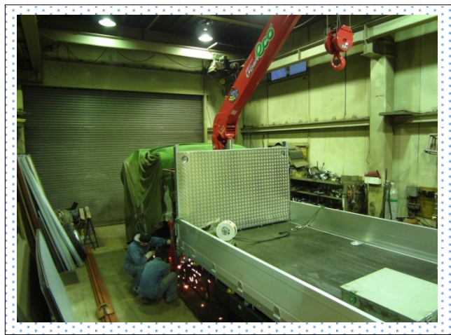
サイドバンパーの取り付け作業
