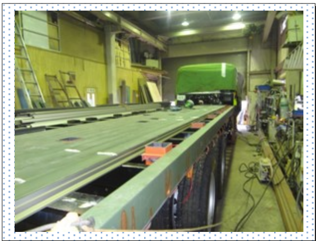
運ぶ荷物に合わせた床板張り作業
