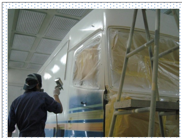
車体塗装作業
