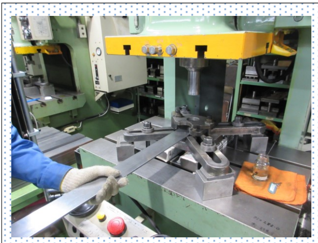
プレス機を使用し、バネを製造します
