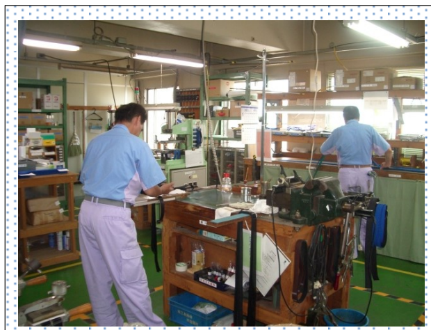
ベルトのカット、接着面の加工（主に研磨）や接着作業などを行っています。
