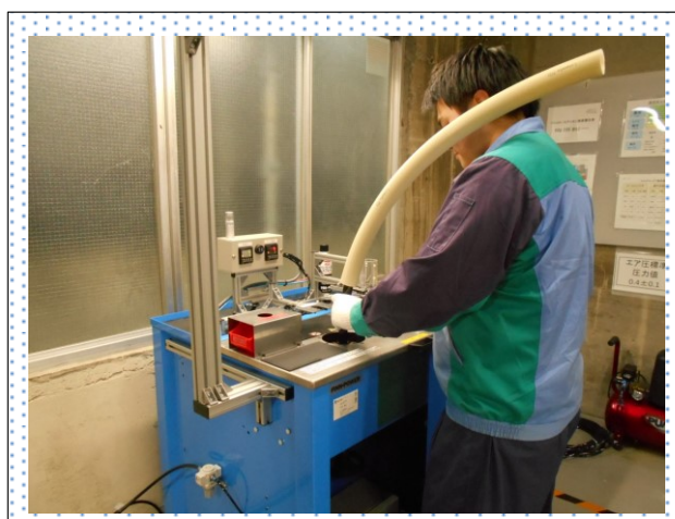
ホースをカットしカシメ作業と呼ばれる金具の取り付け作業を行っています。
