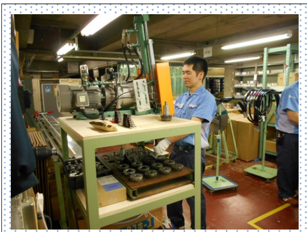
ホースをカットしカシメ作業と呼ばれる金具の取り付け作業を行っています。
