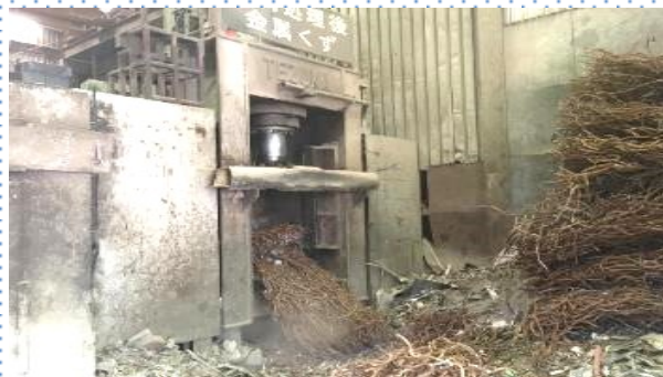
ギロチンに鉄を入れ、切断しているところ
