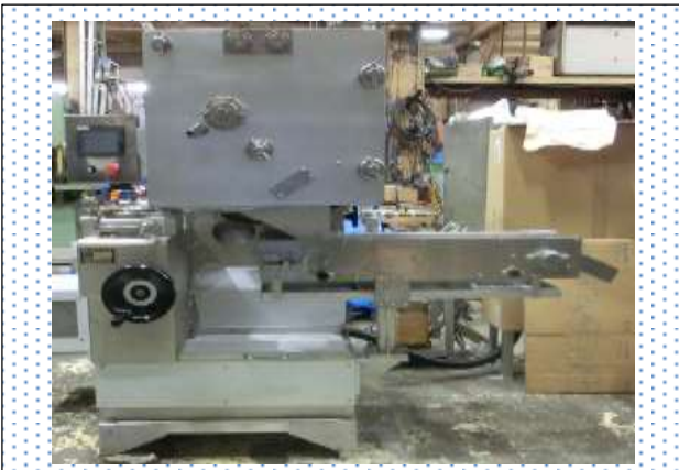
「 スタンピングマシン 」と言う機械で、 色々な形の飴(キャンディー) を作る為に使われています。
