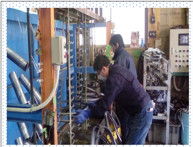
これから鍍金をする製品をラインに投入します
