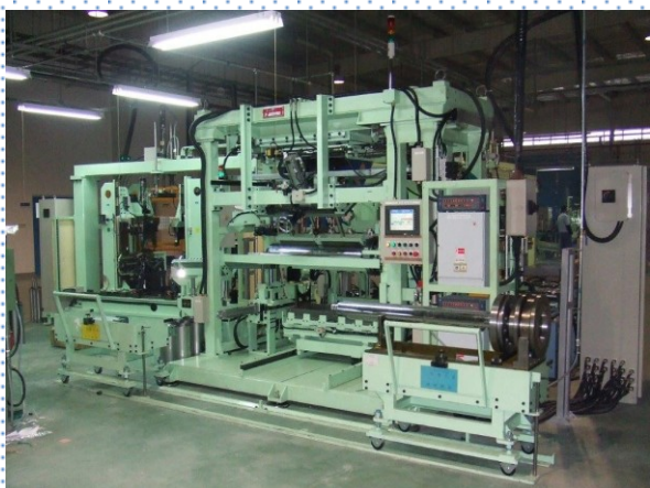
当社製品例(マフラー製造ライン設備)
